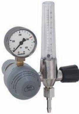
Druckreduzierventil mit angebautem Durchflussmengenmesser mit Feinregulierspindel (dient gleichzeitig als Absperrspindel) und Sicherheitsventil. Messgenauigkeit des Flowmeters +/- 10%. Lieferbar in Ausführungen für drei verschiedene Durchflussbereiche (s.unten).
