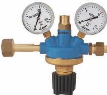
Dieses Druckreduzierventil ist gleich aufgebaut wie Art. 5100 und eignet sich als Zentraldruckregler für kleinere Gasezentralen. Wahlweise bis 60 bar Hinterdruck. Lötnippel am Sicherheitsventil zur Ableitung der Gase ins Freie.
