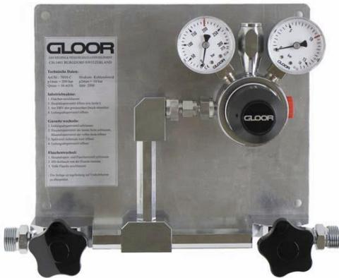
Manuelle Umschaltung für reine Gase bis Reinheit 6.0, bestehend aus zwei Hochdruckabsperrrarmaturen für wechselseitigen Flaschenbetrieb, Hauptdruckminderer mit Sicherheitsventil, sowie Spülausgang. Alle Teile auf Aluminiumplatte mit spezifischer Gasekennzeichnung.
