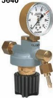
Niederdruckreduzierventil mit Staudruckmanometer, d.h mit Angabe der Entnahmemenge in l/min auf dem Sekundärmanometer. Die Durchflussmenge wird über die Veränderung des Hinterdruckes reguliert.
