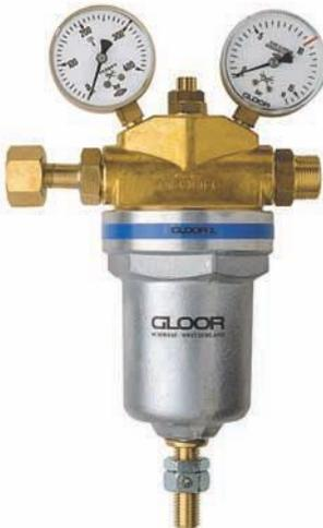
Hochleistungs-Druckreduzierventil (Aufbau gleich wie Art.7900, jedoch für Eingangsdruck bis 300 bar). Mit aufgebauten Inhalts- und Arbeitsmanometern und integriertem Sicherheitsventil. Standardausführung für Hinterdruck bis 10 bar. Als Option bis 20, resp.30 bar (s.unten).
