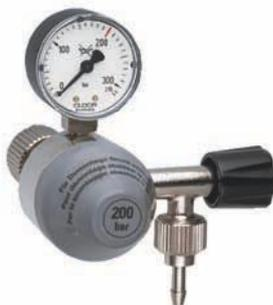
Druckreduzierventil mit Manometer für die Anzeige des Flaschendrucks, jedoch ohne Arbeitsdruckmanometer, mit fest eingestelltem Arbeitsdruck und integriertem Sicherheitsventil. Eine Feinregulierspindel erlaubt eine exakte Regulierung von kleinen Gasmengen (insbesondere auch zur Belüftung von Aquarien geeignet).
