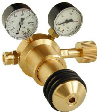
Der Druckregler ist in Versionen für Arbeitsdruck bis 100 bar oder bis 200 bar lieferbar. Der Hinterdruck kann stufenlos zwischen 10 – 100 bar, resp. zwischen 10 – 200 bar mittels Handrad eingestellt werden. Zur erleichterten Druckeinstellung weist das Handrad vorne ein Sechskant auf, so dass die Einstellung des Druckes auch mit einem Inbus-Schlüssel 8mm erfolgen kann.
