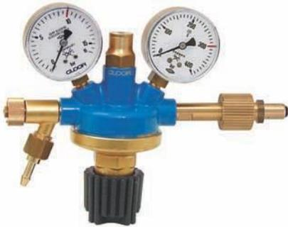
Standard-Druckreduzierventil (Aufbau gleich wie Art. 5100 jedoch für Eingangsdruck 300 bar) mit sehr hoher Druckkonstanz. Mit aufgebauten Manometern, integriertem Sicherheitsventil und Absperrspindel im Abgang.
