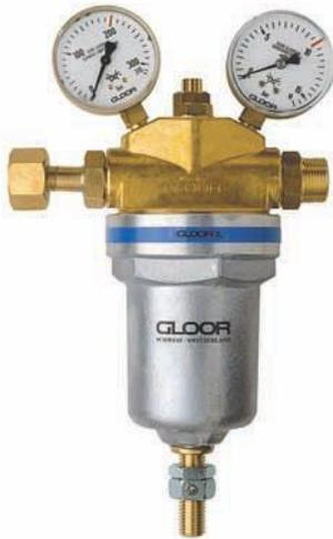
Mit aufgebauten Inhalts- und Arbeitsmanometern und integriertem Sicherheitsventil. Mit Löt nipple am Sicherheitsventil zur Ableitung der Gase ins Freie. Standardausführung für Hinterdruck bis 10 bar. Als Option bis 20, resp. 30 bar (s. unten).
