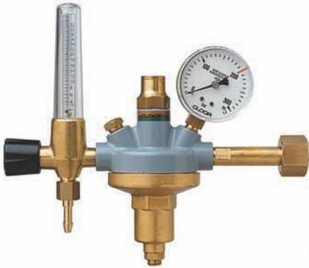
Druckreduzierventil mit angebautem Durchflussmengenmesser und aufgebautem Manometer zur Anzeige des Flaschendrucks. Integriertes Sicherheitsventil und Absperrspindel am Mengenmesser. Der angebaute Mengenmesser mit Schwebekörper ermöglicht eine gute Ablesbarkeit der entnommenen Menge. Messgenauigkeit des Flowmeters  $\pm 10\%$ . Lieferbar in 3 Durchflussbereichen (s. unten)
