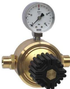
Niederdruckreduzierventil mit aufgebautem Arbeitsdruckmanometer sowie Einstellschraube zum Einstellen des Betriebsdruckes. Membrane aus NBR, Filter im Eingang aus Sinterbronze.
