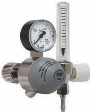
Druckreduzierventil mit Manometer für die Anzeige des Flaschendruckes und angebautem Durchflussmengenmesser; integriertes Sicherheitsventil. Der angebaute Durchflussmengenmesser mit Schwebekörper ermöglicht eine gute Ablesbarkeit der entnommenen Menge. Membrane aus Neopren EFFBE; auf Wunsch ebenfalls mit teflonbeschichteter Membrane erhältlich.
