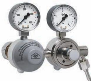
Zweistufiges Druckreduzierventil 300 bar. Durch die zweistufige Bauart weist das Druckreduzierventil eine sehr hohe Druckkonstanz auf und ist somit vor allem für Anwendungen geeignet, welche einen sehr konstanten Hinterdruck erfordern.
