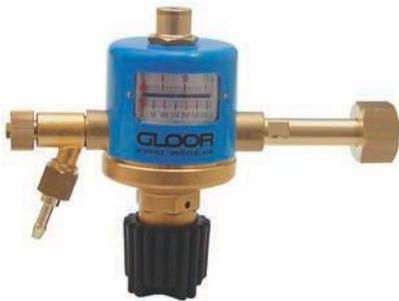
Druckreduzierventil mit zwei eingebauten Manometern, integriertem Sicherheitsventil und Absperrspindel im Abgang.
