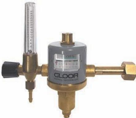
Mit angebautem Durchflussmengenmesser und Anzeige des Flaschendruckes. Integriertes Sicherheitsventil und Absperrspindel am Mengemesser. Messgenauigkeit des Flowmeters +/- 10%. Lieferbar in drei verschiedene Durchflussbereichen (s.unten).
