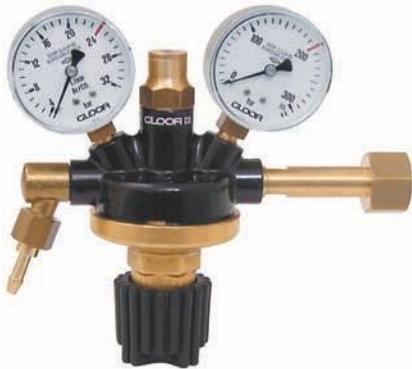
Druckreduzierventil mit Staudruckmanometer, d.h mit Angabe der Entnahmemenge in l/min auf dem Sekundärmanometer. Integriertes Sicherheitsventil. Dieses Druckreduzierventil ist eine günstige Alternative zur Ausführung mit Flowmeter Art. 5150. Bei diesem System wird der Durchfluss über die Veränderung des Hinterdruckes (und durch eine Blende im Abgang) geregelt.
