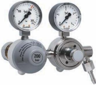
Zweistufiges Druckreduzierventil mit Anzeige des Flaschendruckes und des Arbeitsdruckes. Speziell geeignet für Anwendungen, welche einen sehr konstanten Hinterdruck erfordern (Hinterdruck fest eingestellt nach Wunsch zwischen 0,5 bis 3 bar). Ebenfalls für Analysegeräte mit teflonbeschichteter Membrane erhältlich.
