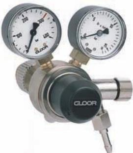
Druckreduzierventil mit aufgebauten Manometern, integriertem Sicherheitsventil und Absperrspindel im Abgang. Anschlussstutzen nach hinten, Druckeinstellschraube gegen vorne. Material: Messing, vernickelt, Sinterfilter aus Bronze; Membrane aus Neopren EFFBE.
