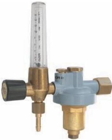
Niederdruckreduzierventil mit angebautem Durchfluss-Mengenmesser mit Absperrspindel. Der angebaute Mengenmesser mit Schwebekörper ermöglicht eine gute Ablesbarkeit der entnommenen Menge. Messgenauigkeit des Flowmeters +/-10%. Lieferbar in drei Durchflussbereichen (s. unten).
