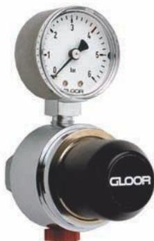
Niederdruck-Reduzierventil für hochreine Gase (6.0). Sinterfilter im Eingang, Druckregulierung über Metallmembrane. Arbeitsdruckmanometer stufenlos regulierbar, wahlweise 0-4 oder 0-10 bar.
