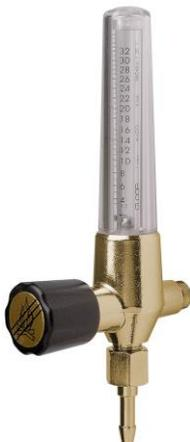
Durchflussmengenmesser einzeln, Messgenauigkeit +/-10%, mit Absperrspindel. Ausgelegt auf einen Eingangsdruck von 4,5 bar; in drei Durchflussbereichen lieferbar : 0-3, 0-16 oder 0-32 l/min.
