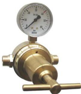
Niederdruckreduzierventil mit aufgebautem Arbeitsdruckmanometer sowie Einstellschraube zum Einstellen des Betriebsdruckes für Arbeitsdruck bis 40 bar. Membrane aus NBR, Filter im Eingang aus Sinterbronze.
