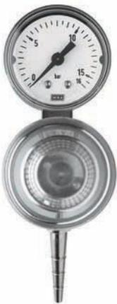
Druckreduzierventil mit Flascheninhaltsmanometer. Durchfluss bei voll geöffneter Regulierschraube alternativ 0.25, 0.5, 1.5 oder 2.5 l/min. Die Druckregulierschraube dient gleichzeitig als Absperrspindel. Speziell geeignet für Anwendungen, welche einen genau definierten Durchfluss und Hinterdruck erfordern.
