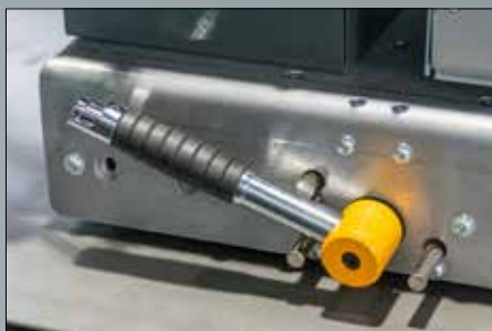
Optional kann ein Bodenmagnet eingebaut werden, welches bei leichten Steigungen für die notwendige Magnethaftung sorgt.
