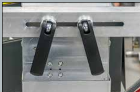
Schnelles Einrichten durch praktische Stellhebel.
