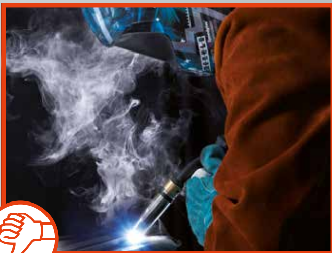
Standard-Schweißbrenner: Starke Rauchentwicklung!
